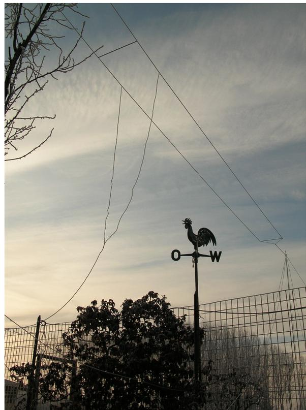
Elettricamente l'antenna marconiana non è altro che una antenna verticale, con la punta che si sdoppia e procede in senso orizzontale. Questa configurazione dà una grande efficienza sulle basse frequenze, e per questo motivo è largamente utilizzata dai militari anche per trasmettere segnali in banda VLF.
